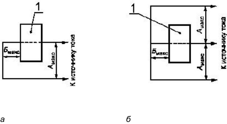
1 - испытуемый трансформатор;  $A_{\max}$  - расстояние между осями проводников соседних фаз в месте установки трансформатора в эксплуатации;  $B_{\max}$  - расстояние в свету от трансформатора до места ближайшего изгиба проводника, служащего в эксплуатации первичной обмоткой трансформатора
